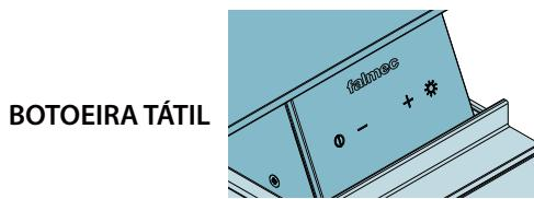
Para aceder ao comando manual, é necessário abrir o painel superior: isto ativa o motor na velocidade 1.
