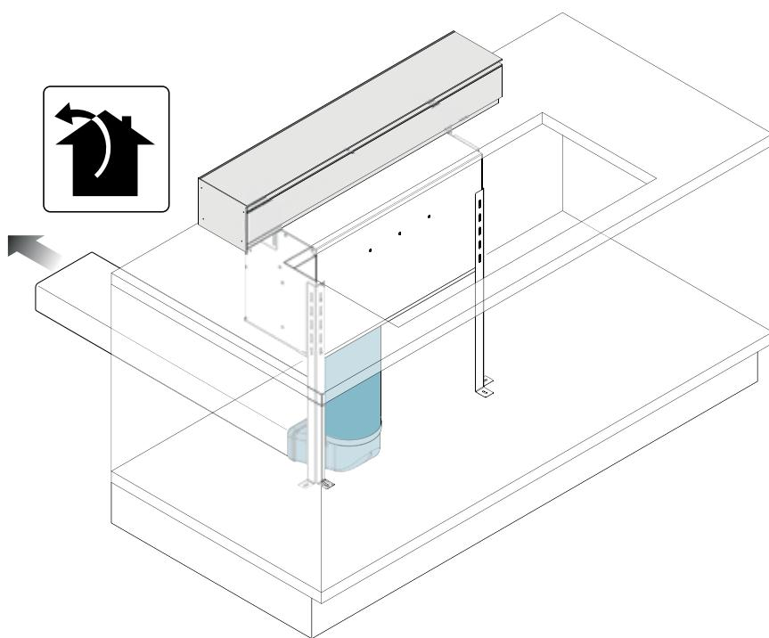
**IT** - Installazione filtro carbone-zeolite (opzionale) (13).
