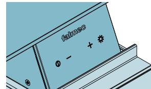
Om toegang te krijgen tot het toetsenpaneel moet het bovenpaneel worden geopend: hierdoor wordt de motor op snelheid 1 geactiveerd.
