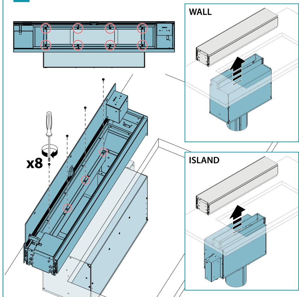
IT - Montare e regolare le staffe di fissaggio al top (7). Montare e regolare le staffe di supporto (8).
