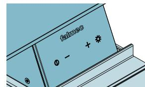
For å få tilgang til betjeningspanelet må toppdekselet åpnes: dette aktiverer motoren ved hastighet 1.
