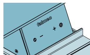
Aby uzyskać dostęp do panelu przyciskowego, należy otworzyć górnego panel: aktywuje to silnik z prędkością 1.
