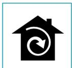
I denne version, passerer luften gennem kulfiltre (i tilvalg) for at blive rensat og recirkuleres derefter tilbage i køkkenet.
