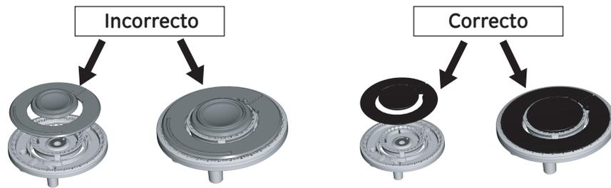
Su parrilla de empotre / gasodoméstico de cristal esta provista de 3 parrillas de fundición con alojamientos en su parte inferior para los pines en vidrio cubierta (ver figura 1). Es muy importante asegurar el asentamiento de las patas de las parrillas contra el cristal para un adecuado funcionamiento de su aparato. Para un correcto ensamble, se recomienda colocar las patas de las parrillas laterales con los puntos marcados en el cristal (ver figura 2).
