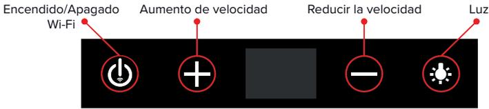
La campana se maneja utilizando el interruptor de control táctil en el panel frontal.
