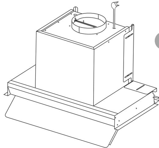
Instale primero las válvulas antirretornos en el adaptador de salida de aire. A continuación, fije el conducto en el adaptador de salida de aire con 2 tornillos (ST2.9\*8).
