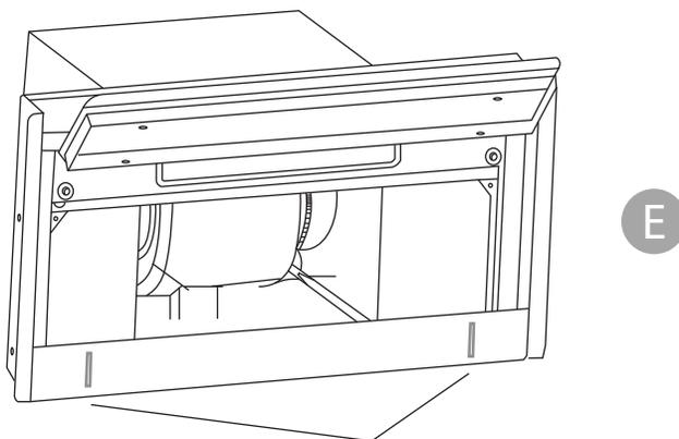
Aflove los tornillos de fijación de la placa posterior 3 para que pueda moverse libremente y, a continuación, bloquee los tornillos hasta que a campana extractora quede ajustada a la posición correcta del mueble.
