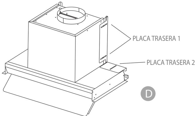
Aflove los tornillos de fijación de la placa posterior 1 y de la placa posterior 2 para que pueda moverse libremente, y bloquee los tornillos de la placa posterior 1 y de la placa posterior 2 hasta que la campana extractora quede ajustada a la posición correcta del mueble.
