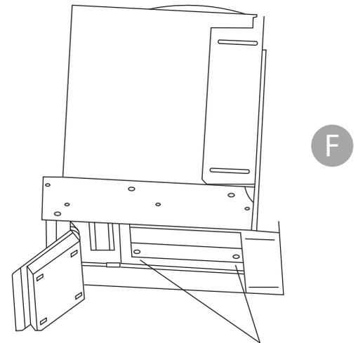
Monte 4 tornillos M4\*18 en los dos lados interiores de la campana extractora para fijarla en el mueble.
